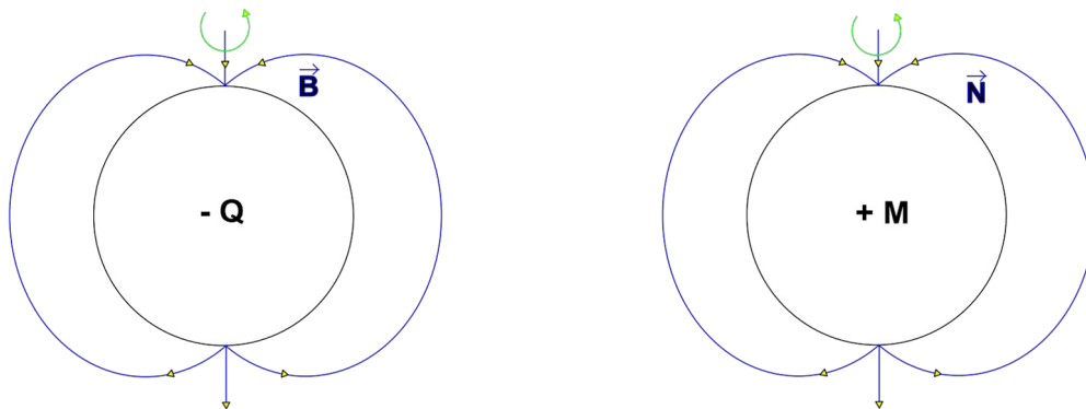
Abbildung 3.2: Eine sich drehende geladene Kugel erzeugt ein Magnetfeld B . Ebenso erzeugt eine sich drehende Masse ein Gravitomagnetfeld N . Das Feldlinienbild ist qualitativ zu verstehen. Zur Bestimmung der Feldrichtung kann in beiden Fällen die linke-Faust-Regel verwendet werden.
