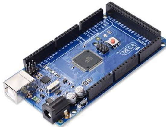
Figure 9. Arduino mega 2560 module
