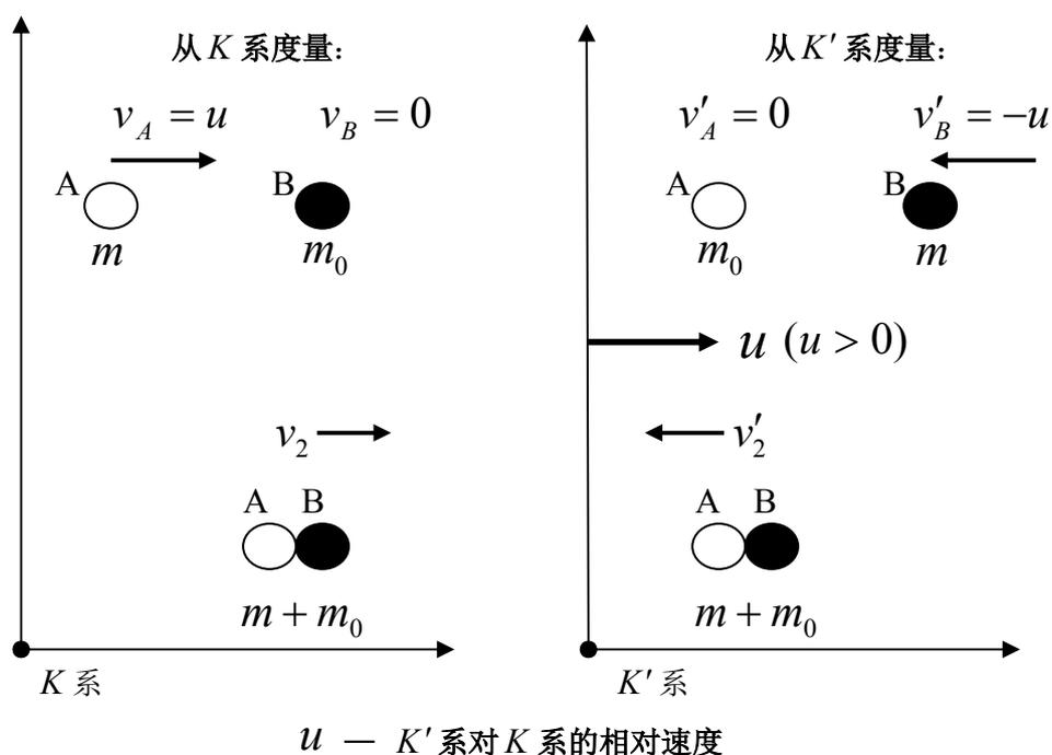
图 1  $K'$  系相对于  $K$  系作匀速直线平移运动
