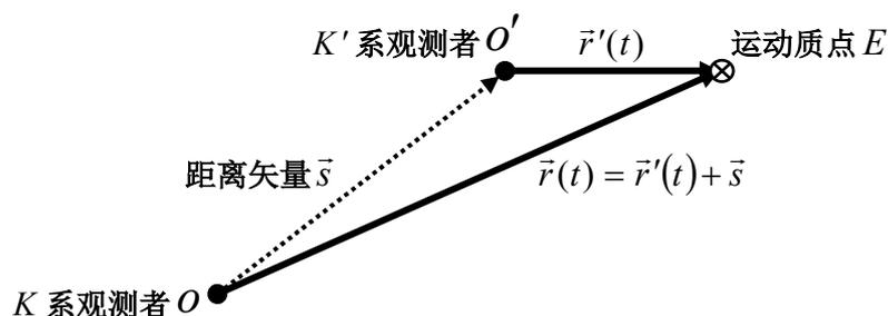
图 1 两观测者同时（ $t \equiv t'$ ）观测到运动质点 E
