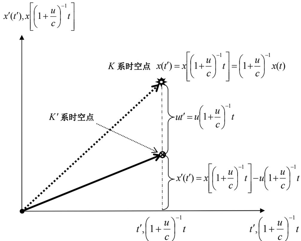
图 9 伽利略变换  $\begin{bmatrix} x'(t') \\ t' \end{bmatrix} = \begin{bmatrix} x \left[ \left(1 + \frac{u}{c}\right)^{-1} t \right] - u \left(1 + \frac{u}{c}\right)^{-1} t \\ \left(1 + \frac{u}{c}\right)^{-1} t \end{bmatrix}$
