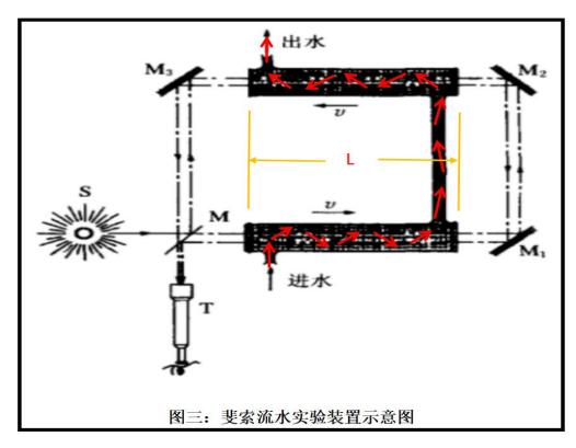
假设介质内部的光速为  $C_1$ 、介质的运动速度为 V、介质的折射率为 n、真空中静止光源的光速为 C,则根据本实验结果有:
