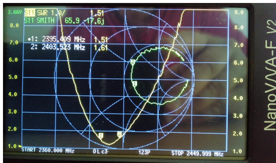
Abbildung 3: Anzeige des VNA. Bei Resonanz (2401 MHz) ist das SWR kleiner als 1,3 (gelbe U-Kurve). Der grüne Kreis zeigt, wie stark sich der Blindwiderstand als Funktion der Frequenz ändert.
