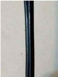
Para trabajar cómodamente, tomamos un tramo de 80 cm de cable bifilar telefónico. Es el cable que encontramos abandonado en la vía pública, aislación en plástico negro, resistente, con 4,2 mm de separación entre ambos conductores aproximadamente.
