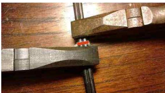
Retorcer media vuelta el cable, por ejemplo utilizando dos pinzas. Cada pinza debe estar separada aproximadamente 2 mm de la marca, para que el punto de cruce de ambos conductores después de la torsión quede exactamente donde pusimos la marca. Es decir, entre el punto de cruce de la torsión y el punto más interno del extremo unido hay 32,7 cm.
