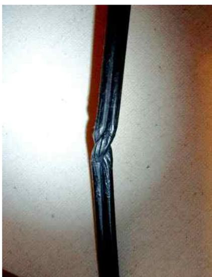
Los conductores intercambian sus posiciones en la torsión de media vuelta. El conductor que en la parte superior de la foto está a la izquierda, pasa a la derecha después de la torsión. El conductor que en la parte superior de la foto está a la derecha, pasa a la izquierda después de la torsión.
