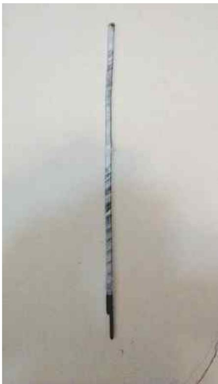
Después de eso colocaremos el conector, sin que la masa toque al extremo libre. La distancia entre la masa del conector y el extremo libre influye en el ajuste de la antena. En las ocasiones que he construido antenas de este tipo, la distancia óptima estuvo comprendida entre uno y dos milímetros.
