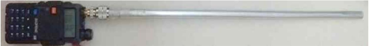
La imagen muestra la antena colocada en un handy Baofeng UV-5R. En zona de ciudad plena, con 1 Watt permite operar perfectamente con repetidoras situadas a 10 Km. Con 5 W se amplía a 20 Km. En ambos casos los correspondientes reciben con buena calidad. Este rendimiento corresponde a la persona de pie con el handy en la mano. En caso de colocar la antena en altura, el alcance aumenta mucho. Es decir que podemos utilizarla como antena de una estación fija.
