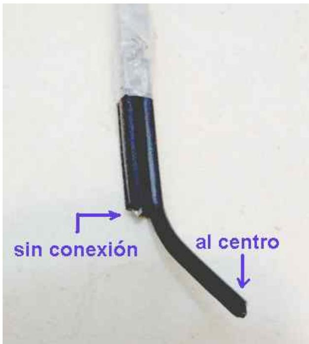
En la imagen se ve una cinta plástica que envuelve a los dos tramos juntos. Los dos tramos deben quedar fuertemente apoyados uno contra otro. Una posibilidad es usar tanza incolora para envolver juntos ambos tramos. Recomiendo eso. En caso de no tener tanza, envolverlos juntos con plástico transparente que cortaremos en forma de cinta. Este último fue mi caso.
