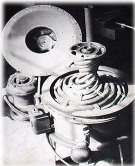
Рис. 5 Конструкция подводящих трубок одной из конструкций В.Шаубергера.
