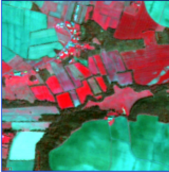
Figure VII.1 : Composition colorée d'une image Spot-5 (10m) en fausse couleur (PIR, R, V)
