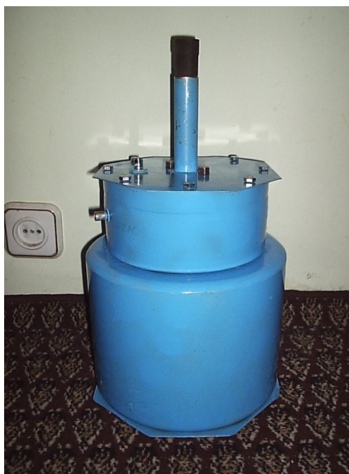
Рис. 21. Фотография клетки Фарадея в сборе.
