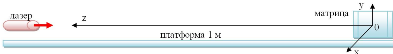
Рис.1. Схема галактического панорамного спидометра. Лазер и матрица жестко закреплены на платформе, которая закрыта кожухом для защиты от влияния внешней среды.
